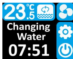
شکل ۶- وضعیت استفاده از پمپ تخلیه در کارکرد عادی حالت اتوماتیک و هنگام تخلیه آب (در حالت سرمایشی)
