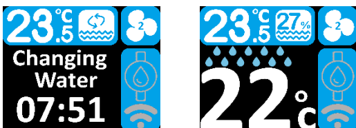
شکل ۵ - وضعیت استفاده از پمپ تخلیه در کارکرد عادی حالت انوماتیک و هنگام تخلیه آب (در حالت سرمایشی)
