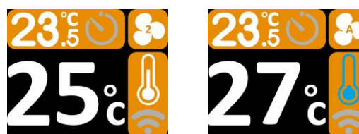
شکل ۴ - وضعیت علامت دماسنج در حالت گرمایشی
