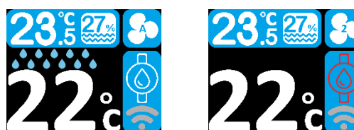
شکل ۵ - وضعیت علامت سنسور اتصال در حالت سرمایشی
